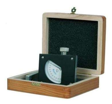
Para determinar la dureza Shore, escala D de probetas y artículos de goma de dureza media, según la norma UNE EN ISO 868, ISO 48-9, ISO 7619, DIN 53505 Y ASTM D 2240-15. Se usa en los siguientes tipos de materiales: Gomas y plásticos de dureza media. Yesos y escayolas. Otros.
