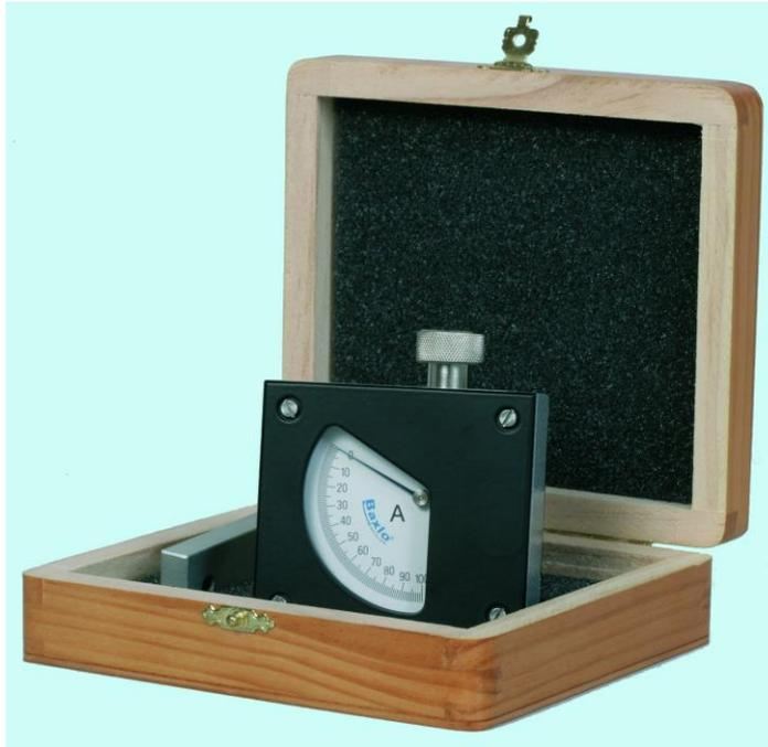
Para determinar la dureza Shore, escala A de probetas y artículos de goma de dureza media, según la normas UNE EN ISO 868, ISO 48-9, ISO 7619, DIN 53505 Y ASTM D 2240. Se usa en los siguientes tipos de materiales: Gomas y plásticos de dureza media. Yesos y escayolas. Otros.
